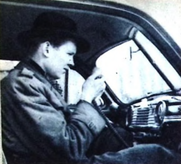
Bilradiostationen i tjänst — man lyfter mikrofonen från en hållare på instrumentbrädan, trycker på en knapp och talar.
