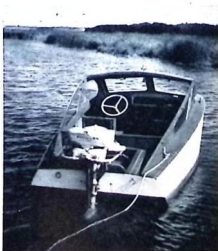
Båten har en Jonsson-stormbåtsmotor på 22 hk. Vid regn kan man spärra en sufflett över hela kabinen.
