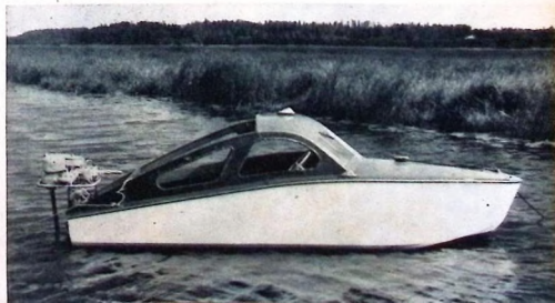
Båten har en Jonsson-stormbåtsmotor på 22 hk. Vid regn kan man spärra en sufflett över hela kabinen.
