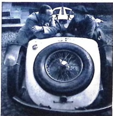
Keinänen diskuterar ett trimningsproblem med en av sina "mekan". Reservhjulet är fäst inbakat i karossen.
