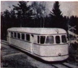
Prototypen till de smalspåriga rälsbussarna är ovan och nedan ute på en provtur i närheten av Eksjö. Den nya rälsbussen tillverkas för två olika spårvidder och kommer senare också att efterföljas av en liknande typ för normalspår.
