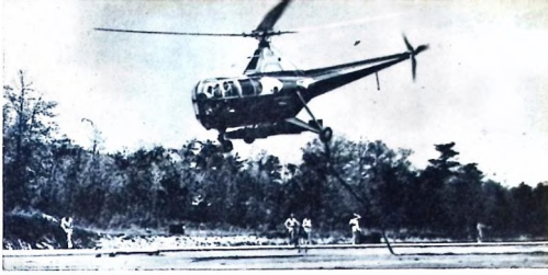
Helikoptern har blivit ett viktigt instrument i jakten efter nya olje- och mineralfyndigheter. Här ses en specialbyggd Sikorskyhelikopter med vilken man kan lägga rördredningar även i de mest svårforcerade terrängförhållanden.
