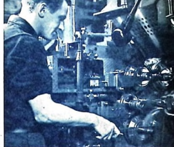
Kullagerstället framställt vid Hofors Bruk och levereras till SKF i form av rör, som utgör utgångsmaterialet för medelstora kullagerlinningar. Av rören svarvas sedan yttre- och innerslagar. Detta sker ovan i en 6-spindlig automatsvarv.
