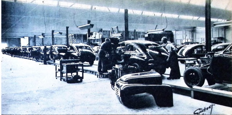
Huvudbanan i den stora monteringshallen. Omkring 15agnar kan samtidigt vara under arbete och de skjuts fram mellan de olika stationerna allt efter det att monteringen fortskrider.
