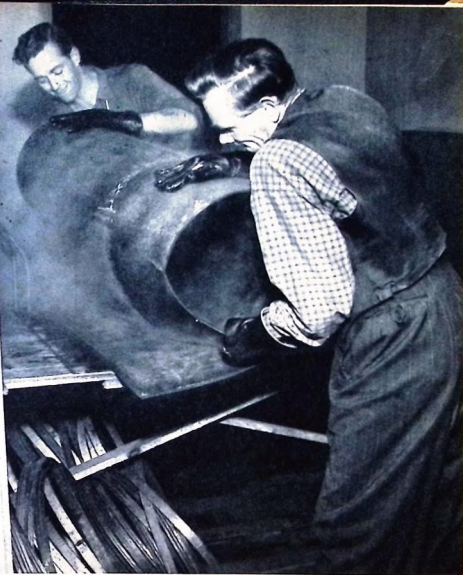
Ett hett kemiskt bad har gjort den sköra masoniten stark och elastisk. Två man kan böja den utan ansträngning.
