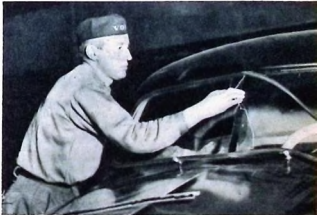
Insättning av fönster går på några sekunder. Man lägger rutau på sin plats, drar ut ett snöre som sitter i gummipackningen och fönstret sitter fast.
