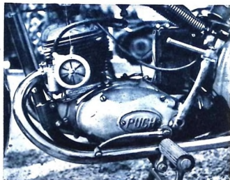
Motorn på sportmodellen har dubbla förgasare och ger 7,5 hk vid 5.500 v/min.
