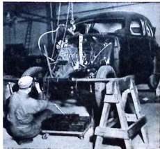
Vid första stationen på huvudbanan monteras motoraggregatet och axlarna med hjulen.
