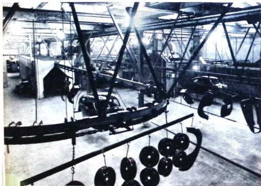
Här ses en del av det ultramoderna måleriet. T. v. syns en av de torkugnar vilka är de enda i sitt slag i Sverige. För att bandet skall kunna gå genom ugnen är dessa båda gaviar öppna, men på grund av det höga lufttrycket i lokalen strömmar ingen värme ut.
