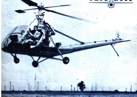
HILLER 360 — en ny helmetallhelikopter från United Helicopters — har nyligen fått tult-världigetsbevis. Kontrollsystemet är mycket enkelt och skiljer Hiller 360 från andra helikoptertyper. Marschfarten är 120 km/t, flygsträckan 320 km och tjänstestopphöjden 3 000 m. Helikoptern är bill anmärkningsvärt billig, men något pris har ännu inte fixerats.
