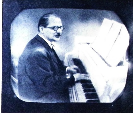
Och så här såg det ut på skärmen på mottagaren. Bildfältet består av 405 horisontella linjer och hela sändningen och mottagningsproceduren går till ungefär som vid telefonsändningar. Skillnaden mellan hastigheterna är emellertid enorm. Att skicka ett telefonsat omkring 80 minuter, medan det endast behövs 1/50 sekund för att sframkallas en bild på televisionskärmen.
