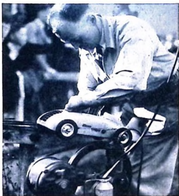
Någon ting för »Göttingarna» och andra svenska modellracercentraler är denna startapparat som drivs av en elmotor vars varvtal hålls konstant av en luftkompressor
