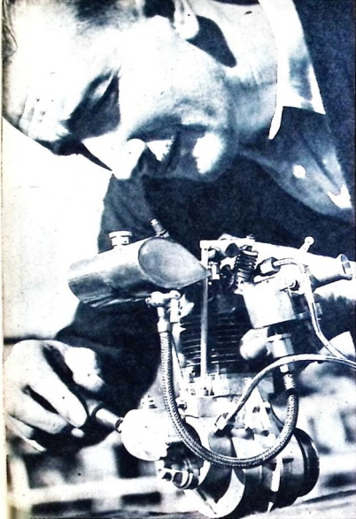
Den här toppventilade modellmotor kan NORMAN COOPER betrakta med stolthet. Motorn är en vattenkyld fyrtakare som Cooper har installerat i en modellracebåt. Båten har kört ca 80 km/t.
