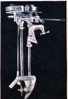
ELIOS 33: cylindervolym 33 cm 3 , varvtal 4.000 v/min, effekt 1,2 hk, bränsleförbrukning 0,8 l/tim, vikt 7 kg. Magnetsändningen är av typ Marinelli-Bosch.
