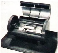
T. v.: Modell av linspektroskop med vilken man kan undersöka hur ett radioaktivt ämnes elektronutsändning fördelar sig på olika hastigheter. Bålfärdsväret är uppskuret så att man ser de spiralförmiga elektronbanorna. — T. h.: Docent KAI SIEGRAHN i sitt laboratorium framför en av de i atominstitutet så vanliga impulsräknarna, vilka mäter den radioaktiva strålningens intensitet.
