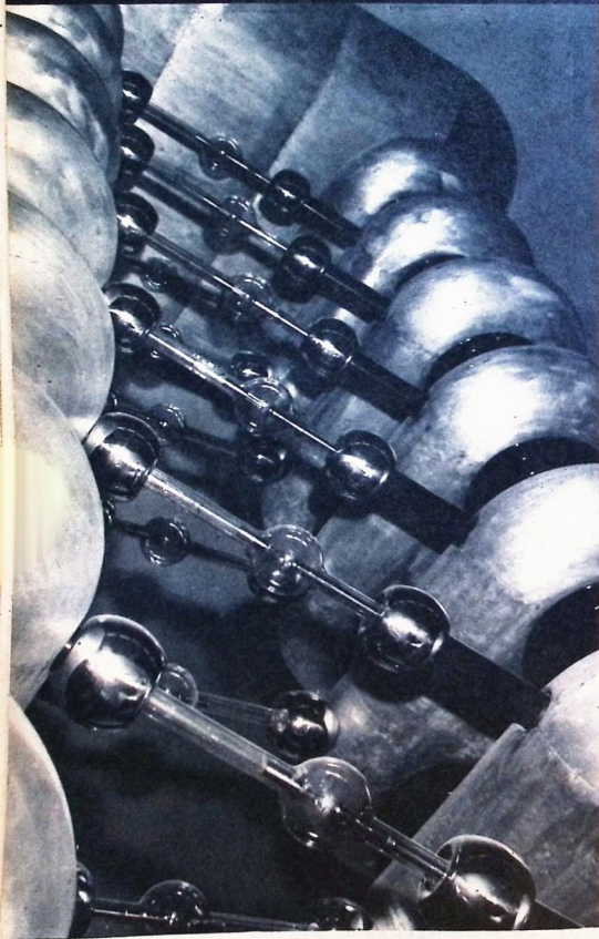
Den nio meter höga kaskidgeneratoren sträcker sig genom tre våningar. De diagonala dragarna glidburen är likriktare och de stora aluminiumkåporna hindrar överslag. Mellan kåporna har man lagt grova porslinsisolatorer.
