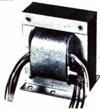
En transformator av standardtyp — en mättransformator med glödlampa och anodlindningar. Till höger syns termomängdningen, som består av en i lindningens insatser strömlös av lättsmält metall. Vid 70 à 80° smälter denna, varvid kontakten till primärströmmen brytes. Transformatorn kostar 25 kr.
