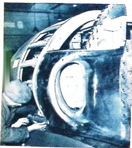
3 De olika delarna monteras i speciella jiggur och här pågår sammansättningen av motorkåpan med luftintagen. På grund av reaktionsmotorns stora bredd har bakre delen av flygkroppen blivit sfärisk än på J 21A.
