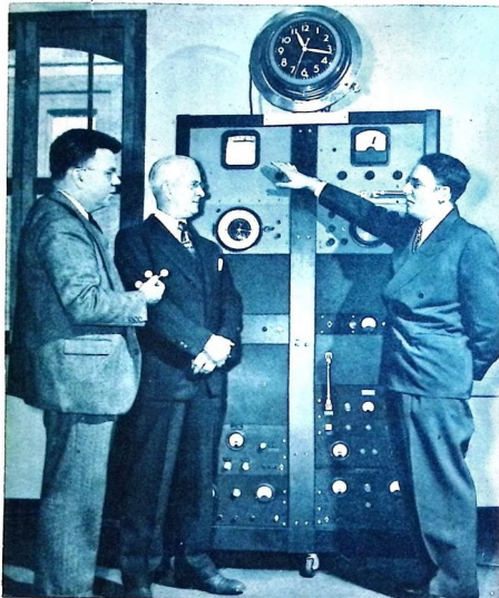
»Atomuret» i Amerikas institut för måtnormaler (National Bureau of Standards) påminner till det yttre rätt så mycket om det »kvartsu», som här i Enköpings Radio- och Kontrollstation och varifrån »Fröken Urs» får tiden. Huvuddelen av apparaturen är radioteknisk, fastän frekvensen hos »atomurets» oscillator är 23.870.000 p/s mot 50.000 p/s vid »kvartsu». Atomuret är också till skillnad från kvartsuuret oberoende av temperaturen.
