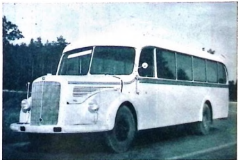
Denna turistbuss är byggd på ett 5-tonns chassis med kaross av helt ny typ. Den finns i två olika modeller, en för stads- och en för landsvägstrafik. Dieselmotorn är på 120 hk.
