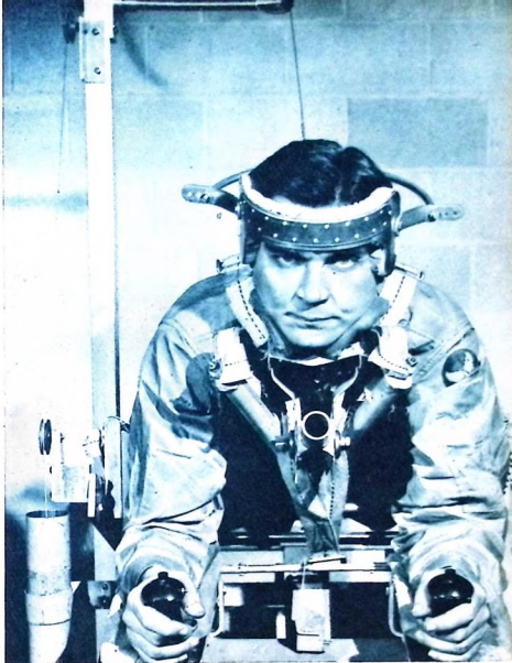
Försöksmodell för utprovning av pilotbild. Observera motvikten som håller upp huvudet.
