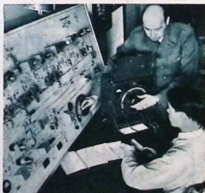
Arméingenjör Lundén håller föreläsning med furir Göransson om den 3-watts bärbara radiostationens konstruktion. På panelen till vänster är delarna uppmonterade på sina platser i schemat.
