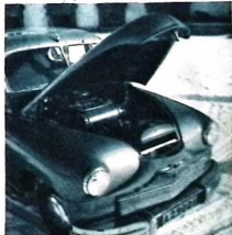
Motorhuven är fjäderbelastad och behöver inte stöttas. Obs! den stora luftrenaren.
