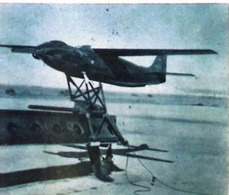
OQ-19A monterad på katapultvagnen. Modellen är radiostyrd och kan utföra bl. a. loopings, rollving över och dykning.
