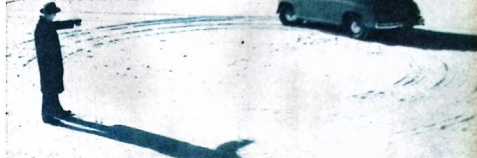
Hjulspåren i snö visar tydligt vagnens korta vändradie. Diametern på cirkeln är 10 m.
