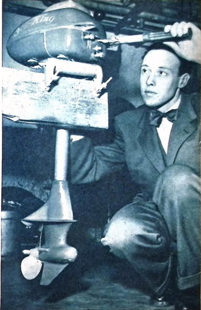
Ingenjör HOLGER OLSSON betraktar sin lilla strömlinjeformade aktersnurra som han konstruerat och byggt på endast fem månader. Motorn väger 12 kg och beräknas i serietillverkning kosta omkring 850 kr. Effekten är 2,5 hk, vilket räcker för en fart av 4 knop. En verklig snäckmotor för sommarnöjet.
