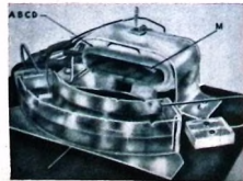
Den rektangulära spolen ABCD omger magneten M som är upphängd i en tråd. Den nas andra änden är dragen ned i vattnet i det halvkugliga plasträtet.
