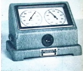
Ett mekaniskt räkneverk speciellt avsett för räkning av impulser från Geiger-Müller-rör i samband med mätning av radionuklivitet. Räknekapaciteten uppgår till 300 impulser sek — alltså ca 20.000 impulser/minut.
