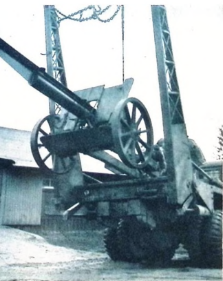
Lyftbommen på Brockway-vagnen orkar med 4 ton. Med full last drar bilen en 14 l bensin per mil på bra väg. Max-fart 80 km/t.
