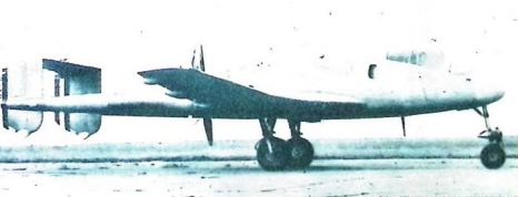
N O. 8.000 heter ett nytt franskt luftfartfartygsbaserat jaktplan med två trebladiga motroterande propellrar som drivs av en 2.370 hk Juno 713-motor. Spännvidd 11,75 m, längd 11,80 m, vingyta 38,5 m², toppfart 730 km/h, flygsträcka 4.500 km, samt startvikt 7000 kg.
