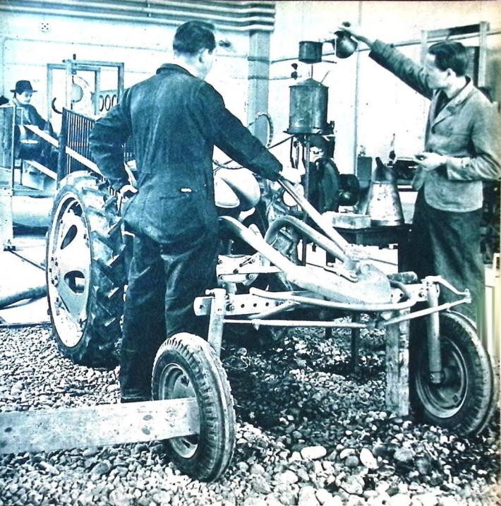
För att fastställa remskiveeffekten bromsas traktorn med en elektrisk effektvåg. Här ses den nya Allis Chalmers under prov
