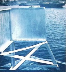
En radarreflektor provisoriskt utförd av en träställning överdragen med aluminium.
