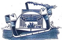
Sir Henry Bessemer löste problemet med den tekniska sjösjukemedelnen genom att hydrauliskt stabilisera en salong midskepps.
