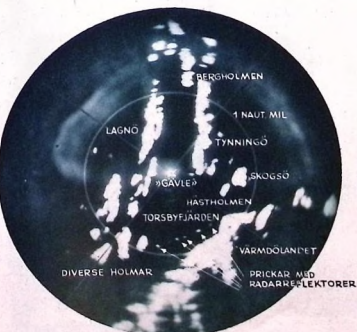
Detta är ett foto av radarskärmen som visar exakt samma situation som »Jökortet t. v. Med »Gävle» i centrum syns Tynningö, Lagnö, Värmdö m. m. Observera också de sex radarprickarna.
