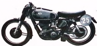
TT-maskinen har en dubbel vaggrum med teleskopfjädrat bakhjul och Teledraulisk framgaffel. Bensintanken rymmer 23 lit.
