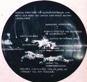
Här har radarskärmen fotograferats när fartyget ligger i hamn i Stockholm. Fotot är taget med en exponeringstid på en minut. Skalan på radarskärmen är sådan att radien utgör 1 sjömil.
