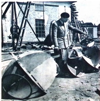
Fyringenjör Bengt Holm i Lotsstyrelsen demonstrerar sina radarreflektorer av typen hörnreflektor och avsedda att monteras på prickar och bojar. Träfoten skall möjliggöra det senare.
