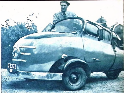
Reparatör ARNE LÖÖF vid sin egenhändigt byggda folkvagn. Den grönsvartglänsande bilen är trehjulig med individuellt fjädring på alla hjul. Materialkostnader: ca 1.000 kr.
