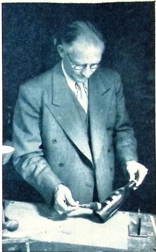
En pilsnerflaska med fingeravtryck som framträtt efter bepudring med argemontblanding och DM-pulver eller a. k. svartpulver.
