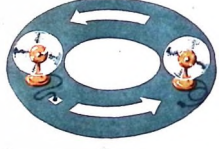
Centrifugalkraften är den viktigaste delen i den flytande kopplingen. Vätskan slungas ut mot periferin och åstadkommer på så sätt det tryck som är nödvändigt. (Bilden ovan.)
