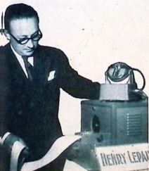
Med hjälp av denna franska apparat kan en urmakare på ett elektrodiagram se om klockan går rätt.
