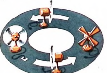
Teckningen ovan: Phiveas två fläktar mitt emot varann och den ena släpps i gång, så börjar bladen att rotera också på den andra. Phiveas fläktarna på en cirkulerande platta får vi en exakt kopia av principen för den flytande kopplingen. — Därunder: Principen för den hydrauliska turbinväxeln är densamma, fastän det här finns fler turbinhjul med skovelkranar. Vätskan som står still motsvarar den del som bestämmer rörelserna hos vätskan som är kraftförmiddlare.
