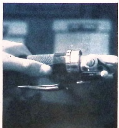
Teleskopfjädring både på fram- och bakhjulet. På den tyska lättniktaren Malco satts kopplingsreglaget i vänstra handtaget. En praktisk finess som gör växlingen snabbare och bekvämare.
