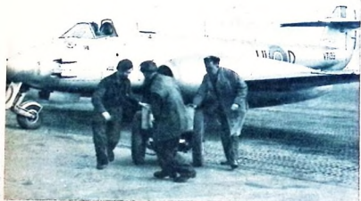
I likhet med vår egen Vampire J 28 startas Meteor IV med ett speciellt startaggregat. Här ser vi hur markpersonalen drar fram ett sådant till ett plan.
