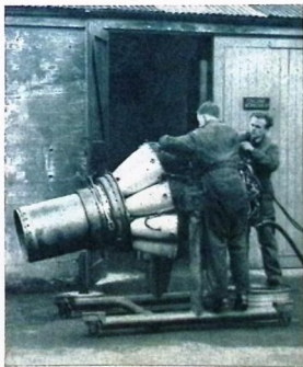
För översynen monteras hela aggregatet ur flygplanet. Arbetet tar dock endast 1½ timme och görs var femte dag.
