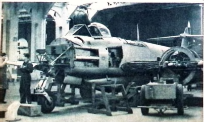
Duxford-flottiljen har stora ljusa verkstadsbangarar för överstyr och reparationer. Här ses en Meteor sönderplockad och klar att genomgå generalöversyn.
