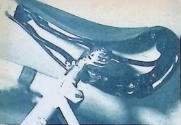
Sadeln sitter numera direkt på sadelstolpen. Alltid minskar det vikten något. Isoleringsbandet för wiren skall ersättas av påladda klammer.
