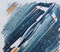
Dubbelraketen A 9—A 10, där A 10 lyfter upp den mindre A 9 till en viss höjd, varefter A 9 fortsätter själv. Räckvidd 560 mil. Teckningen nedan: Under större delen av sin bana ledes projektilen mot sitt mål av en radiostråle, längs vilken V-vapnet förflyttar sig. Under glidflykten i slutet av banan drivas bomben av en komplicerad apparat.
