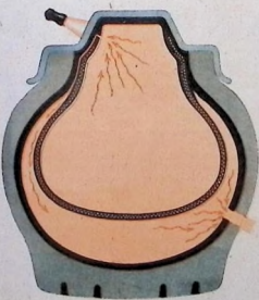
Life-Guard-däcket i genomskärning i explosionsögonblicket. Hålet ses t. h. Den inre slangen är 800 mil och håller luften i 800—1.200 meter.
