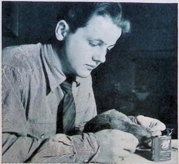
En intressant om också inte alla gånger effektiv metod att påvisa malm i ett malmprov är att låta två ledningar till ett ficklampsbatteri beröra stenen och vara kopplade till en glödlampa. Lyser lampen finns det elektricitetsledande malm i stycket.
