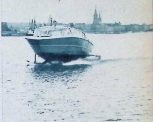
Med en 140 hk motor kan denna 3,5 tons »sjöbuss» komma upp i en fart av 25,2 knop. Propellern är dragande.
