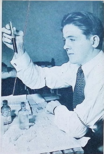
Guld! Vid den mycket invecklade kemiska analysen av guldmalm får man i sista etappen fram en blå fällning om lösningen innehåller guldstoff. Bolidenanalyser har bekräftat guldföremåsterna.
