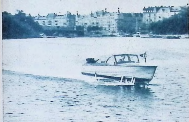
Den här vanliga campingbåt med Johnsons storbåtsmotor gjorde tidigare 16 knop. tack vare bärplanen har toppfarten kommit höjas till bortåt 25 knop.
