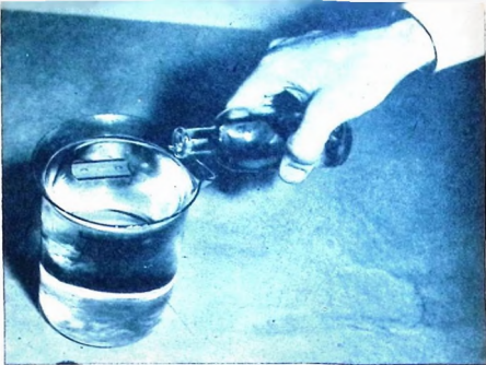
En liten portion av det nya preparatet tillsättes, varvid ytspänningen reduceras till cirka en tredjedel och vattnet börjar tränga över rakbladets yta — snart sjunker det till botten.
