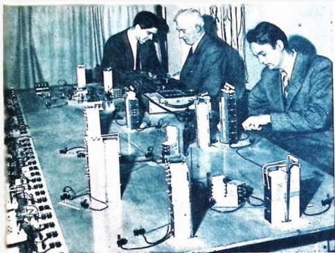
En översiktsbild av modellenläggningen av Sveriges elkraftnät med Skåne och Norrland i bakgrunden. Cvilleingenjör Uno Sörnkvist t. h. kopplar in mätinstrumenten vid Stockholms belastningsuttag för att undersöka verkningarna av en kortslutning i Närke och i Jämtland på kraftförsörjningen i Stockholm. Professor Ragnar Lundholm (i mitten) och civileingenjör Bertil Mattson, den senare vattenfallsstyrelsens representant, avläser mätinstrumenten.
