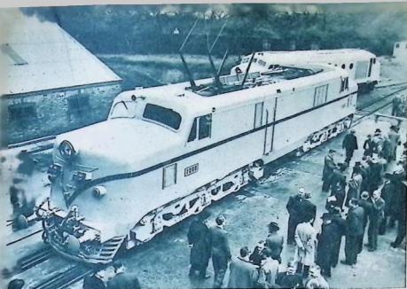
English Electric and Traiding Company har nyligen till Brasilien levererat det största elektriska lok som byggts i England. Bjässen har en styrka på 3.000 hästkrafter och skall användas för expreståg. Vår egen -hela folkets järnväg- står sig dock bra i konkurrensen — F-loket har nämligen 3.500 hk och M-loket har hela 3.600 hk.
