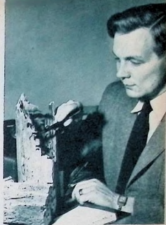
ingenjör Stig Henriksson vid Rönnskärslaboratoriet granskar ett furuskytke som blivit förstörd av myror. Bolidensaltet dater numera stopp för all dylik skadegörelse.
