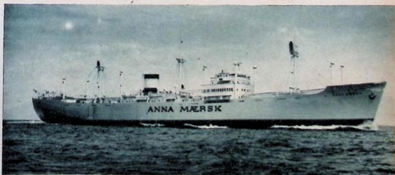
Ett vackert arbete från Eriksberg: lastmotorfartyget »Anna Mærsk», som levererats till ett danskt rederi. Fartyget är på 9.040 ton, har en 9-cylindrig motor, är 135,6 meter långt och går normalt 19,5 knop. Bra fart!
