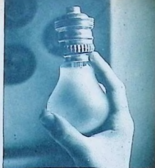
På gamla lamphållare är porstinsringen ofta så låg att man kommer åt gängorna när man t. ex. skruvar fast en lampa. Farligt!
