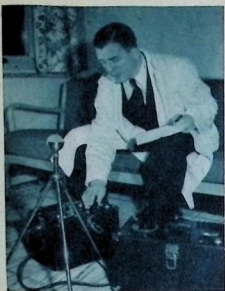
Ingenjör Per Hammarfors använder ljudstyrkan i ett böningsrum. T. v. mikrofon och ljudstyrkemätare, t. h. frekvensanalysator.
