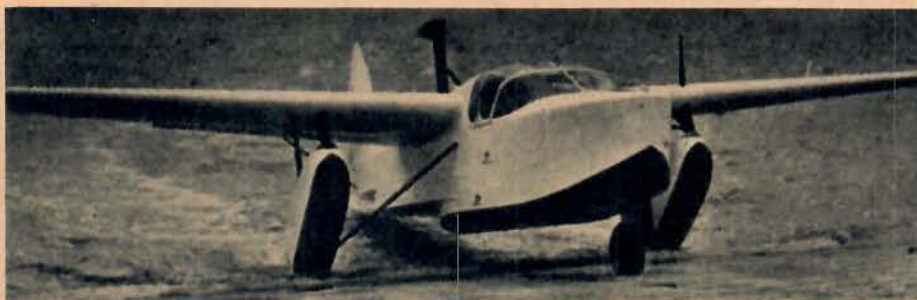
Ett originellt trehjuligt landställe har den tvåsitsiga amerikanska amfibien Spencer-Larsen SL-12C (firmans namn numera Colgate-Larsen). Huvudhjulen sitter nämligen i stödfloetternas bakändar, vilka fälls ner när planet skall gå på marken. Skjutande motor 125 hk Menasco C-4. Spännvidd 12,2 m. Tomvikt 725 kg. Flygvikt 1.009 kg. Material trä.
