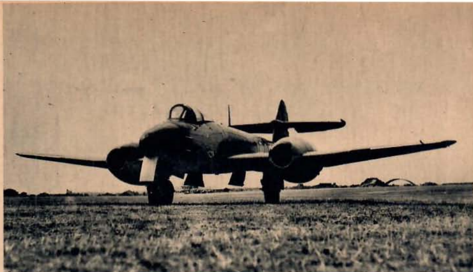
Det brittiska tvåmotoriga reaktionsjaktplanet Gloster »Meteor» var den stora sensationen vid RAF:s strålande uppvisning på Kastrup inför 250.000 köpenhamnare och andra flygintresserade. FLYG presenterar här ovan en bild av »Meteor», som har följande mått: spännvidd 13.71 m, längd 12.50 m, höjd 3.96 m, vingyta 34,74 m 2 . Beväpningen består av 4 st 20 mm akan i nosen. — T v en division Hawker »Tempest» (närmast) och en division Supermarine »Spitfire».
