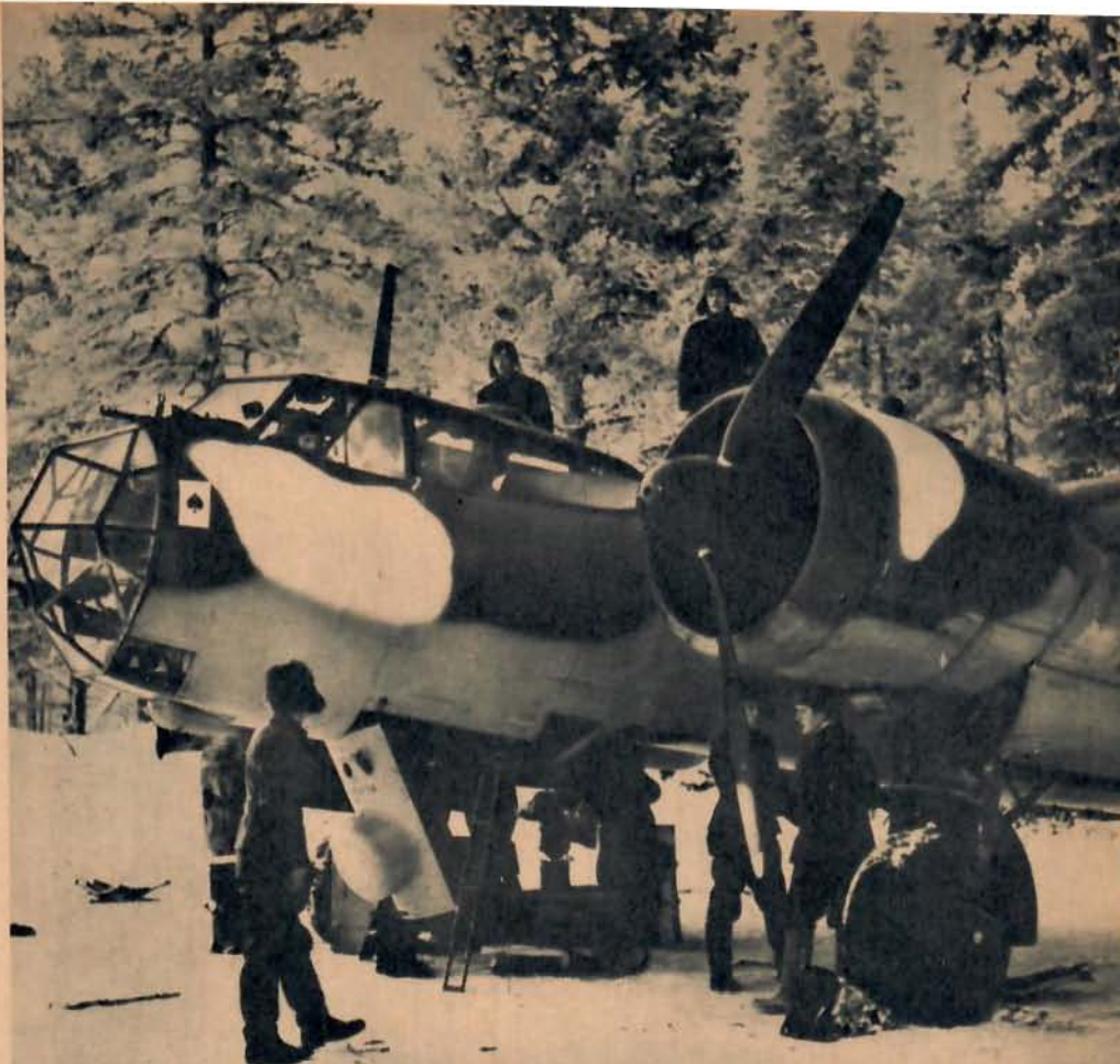
En finsk Dornier Do 17Z — en utveckling av Do 215 och försedd med 2 st Bramo Fafnir 323-motorer på vardera 985 hk. Bevapning 6 st rörliga 7,9 mm ksp, bomblast 1 ton.
