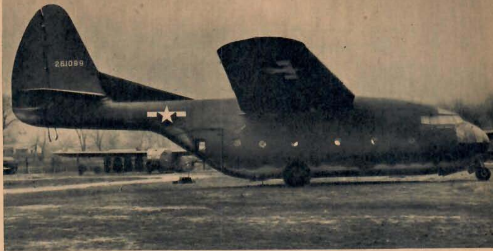
USA:S TVA NYASTE lastglidplan. Här ovan den väldiga Laister-Kaufmann XCG-10A »Trojan Horse» (Trojanska hästen), som tar 42 fullt utrustade soldater ombord. — T h General Airborne Transports XCG-16.
