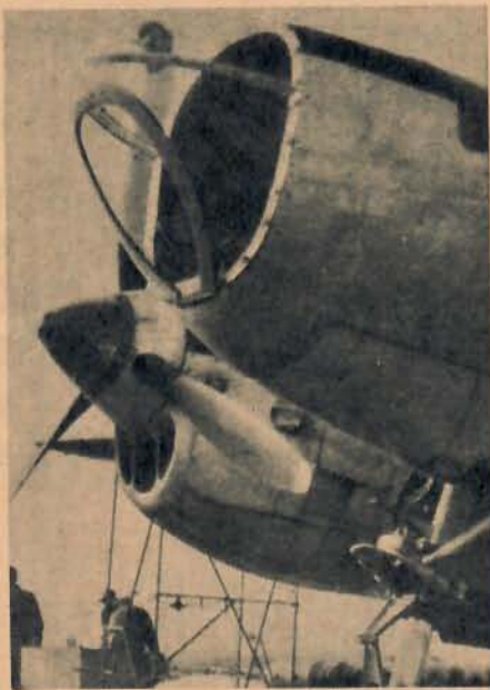
LOCKHEED »LIGHTNING» i tvåsitsig version har fått en ny nos (ovan) med plats för en bombfällare. Versionen används som ledarplan vid precisionsbombning från låg höjd och tar 1.800 kg bomber under vingarna.
