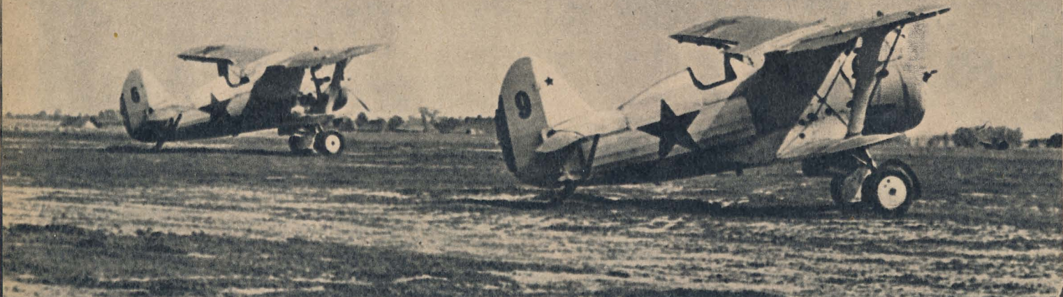
Det ryska jaktplanet I 153 (ovan) var också med i spanska inbördeskriget. Motor: 1 st 775 hk M 25B, maxhastighet 420 km/t, marschhastighet 335 km/t, flygsträcka 630 km, topphöjd 10.000 m, beväpning 4 st fasta 7,62 mm Shkas ksp.
