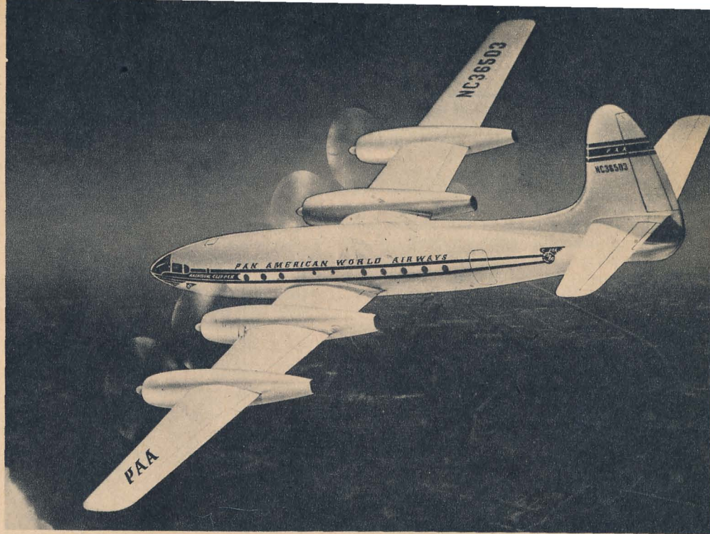
De första teckningarna av det nya Republic-projektet »Rainbow» med 650 km/t marschhastighet på 12.200 m ses här ovan och nedan. — Nedan t v en genomskärning med stolarrangemang och inredning. Obs att motorgondolernas bakändar är längre utdragna på helteckningarna, vilket sannolikt är det riktiga.
