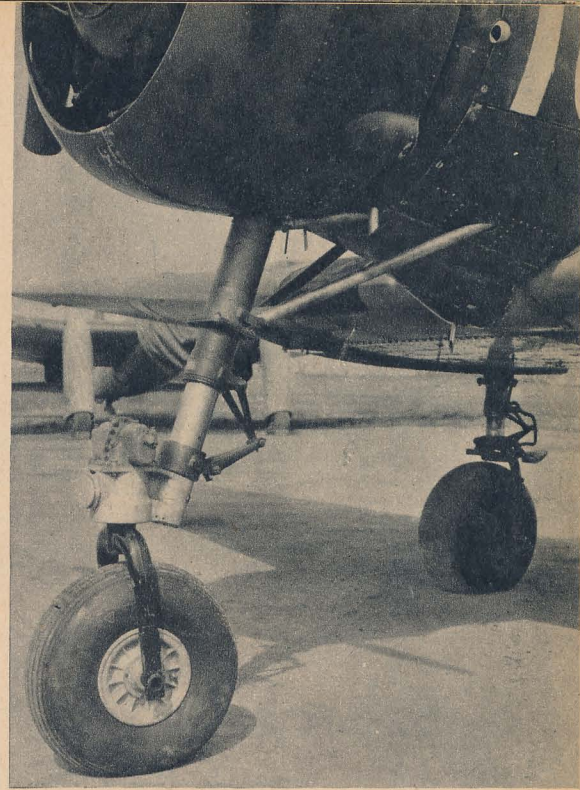
På bilden här ovan ses det första experimentexemplaret av Sk 14 med fast noshjul. T h en närbild, som visar hur noshjulet monterats.
