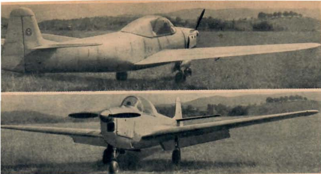
Det franska ensitsiga övningsplanet Morane-Saulnier MS 560 med 75 hk motor och trehjulstätt — synbarligen en god exponent för fransk flygindustri.
