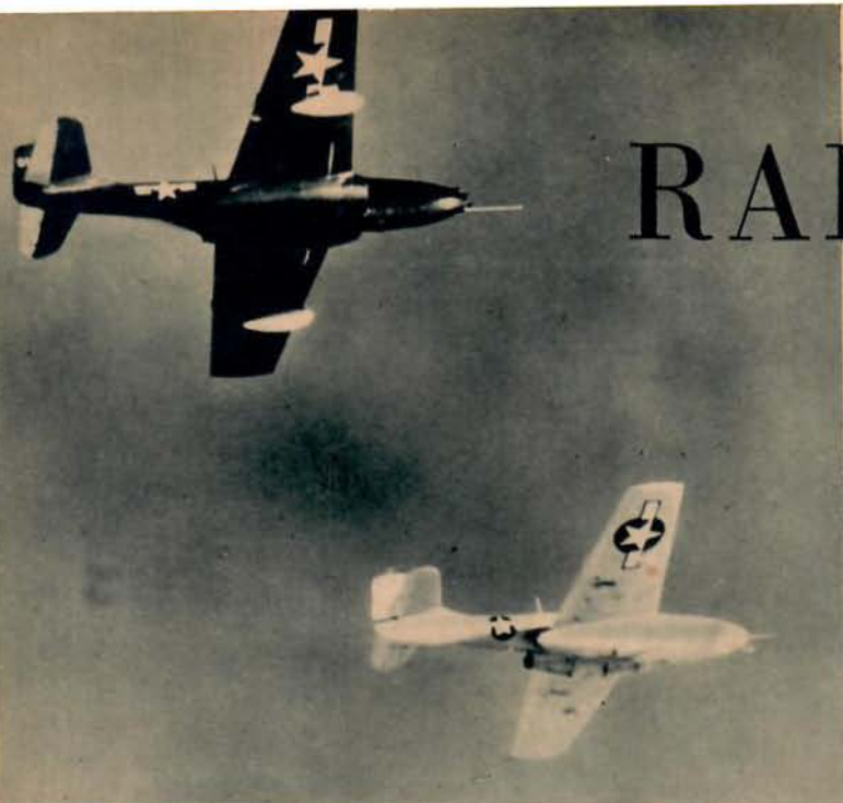
Två reaktionsdrivna P-59 Airacomet under ett prov med »Yehudi». Moderplanet överst och robotplanet underst.
