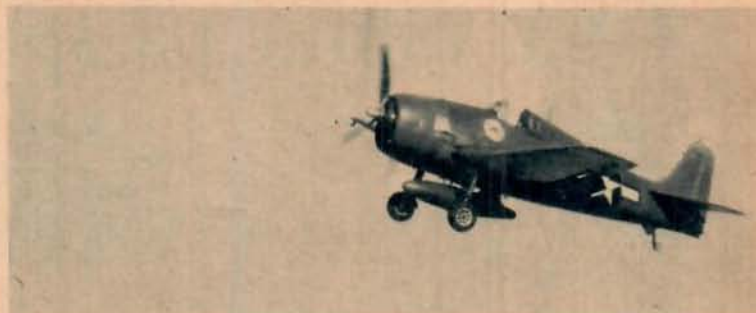
Här nedan radiodirigeras en Hellcat med extratank dels från marken, dels från en Tigercat. — Nederst är robotplanet startklart.
