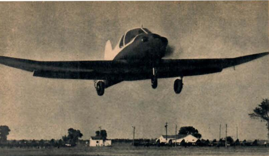
Culver Aircrafts trehjuling modell V är enligt fabriken världens snabbaste flygplan med 85 hk motor. Synbarligen ett av världens mest »genomkonstruerade» sportplan.
