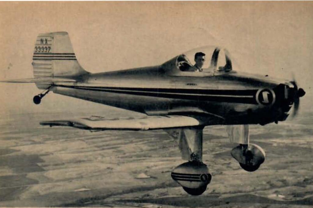
Luscombes nya ensitsiga flygplan modell 10 har fast landställ och 65 hk motor. Vid bygget används i stor utsträckning samma delar som till firmans tvåsitsare Silvaire.
