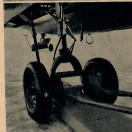
Skidhjulstället på B 17 är en lika god som nödvändig lösning av en svår vinterflygfråga. Av- och påmontering av hjulen sker med vant folk på mindre än en minut. — Nedan ett par typiska vinterflygbilder. — Till höger värms motorn på en B 17 upp på lika och effektivt svenskmannavis. Kapellet utnyttjas som synes även under uppvärmningen. — Bilden till vänster slutligen visar markpersonalen i arbete vid en vinterdepå. Kälken är ett nyttigt redskap även i flygaldern.
