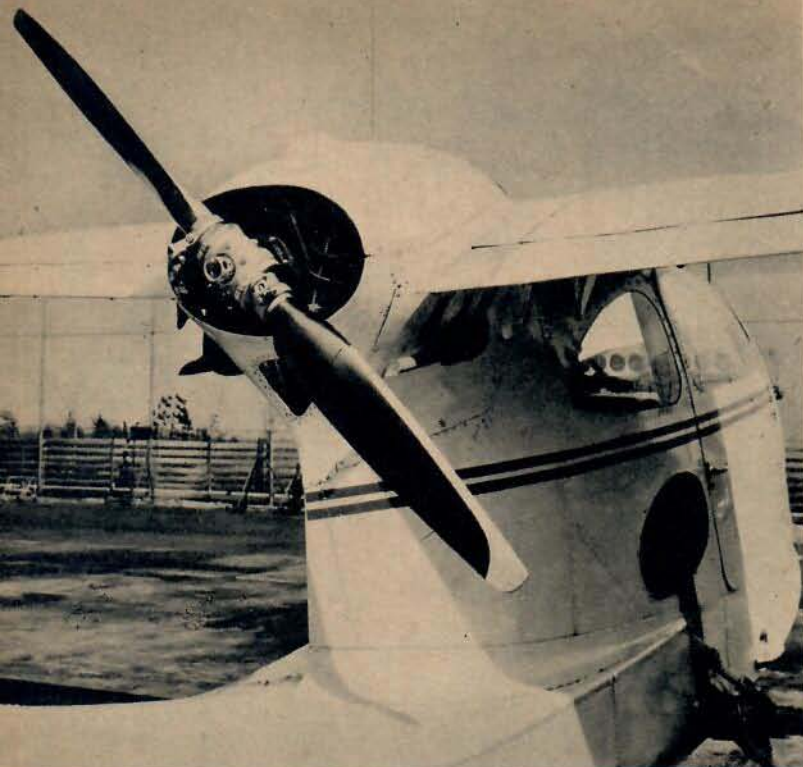
Den nya automatiska constant-speed-propellern Aeromatic 220 ses här installerad på amflyblen Republic Seabee (experimentversion).
