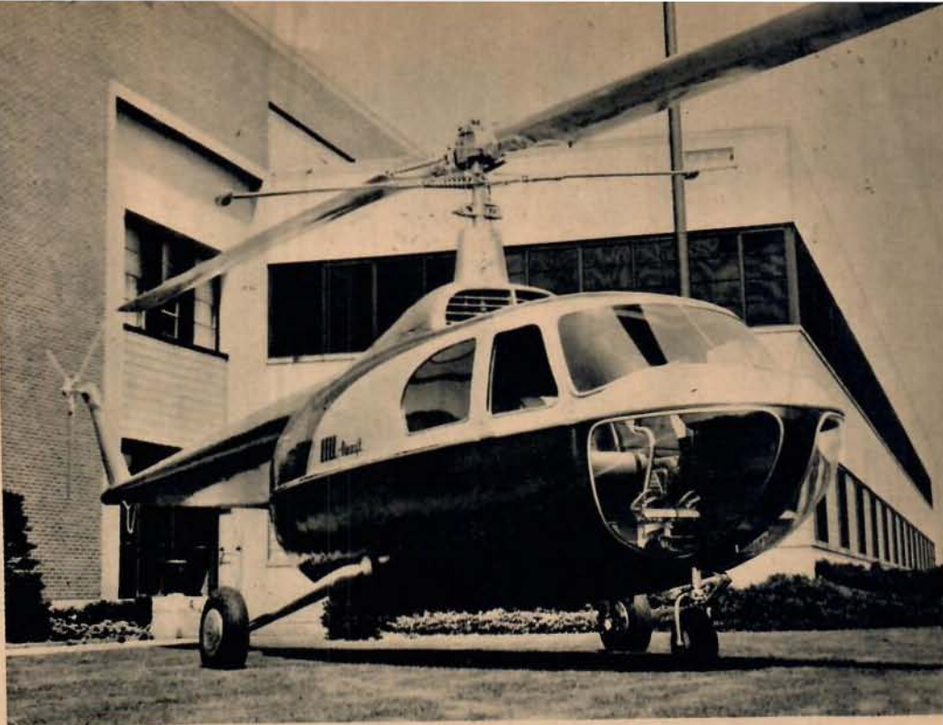
Harovan ses den femsitsiga helikoptern Bell 42 med fast trehjulstill. — Den nedre bilden visar tvåsitsaren Bell 47 svävande strax över gräsmattan utanför Bell-fabriken. »Stängens» som sitter i 90° vinkel mot rotorbladen är en automatisk gyrostabilisering för rotorn.
