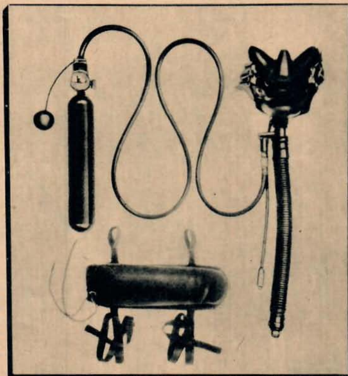
Fig 4. Modern syrgasutrustning för fallskärms hopp. Jämf även fig 1 (nr 12/46), där flygaren är samsatt med ett koppla om från demand-systemet till fallskärmsutrustningen.
