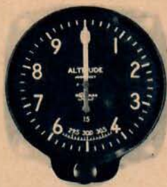
HÖJDMÄTARE , upp till 20.000 fot. Varje grad motsvarar 200 fot. Ett visarvarv är 10.000 fot.
