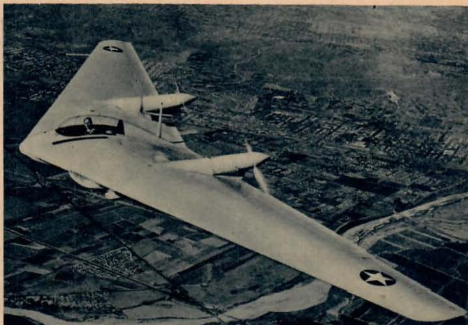
NORTHROP N-9-M är beteckningen på en försökstyp som byggdes i tre exemplar alternativt utrustade med 275 och 325 hk motorer.
