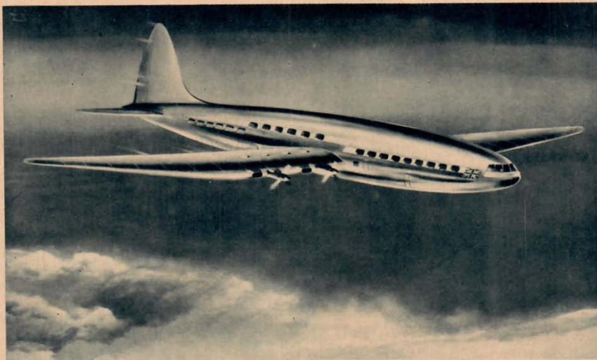
Störst av alla de brittiska transportflygplan, som nu äro under bygge, är Bristol Brabazon-planet, vilket drives av åtta Bristol Centaurus motorer och kommer att ta femtio passagerare utan mellanlandning på den nord-atlantiska routen mellan London och New York.
