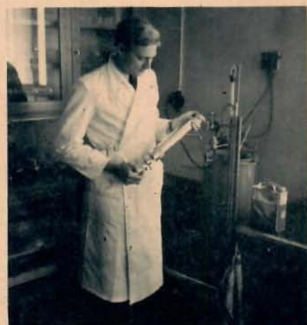
Ingenjör Hallin på Shells laboratorium gör en ångtrycksbestämning på nyinkommen flygbensin.
