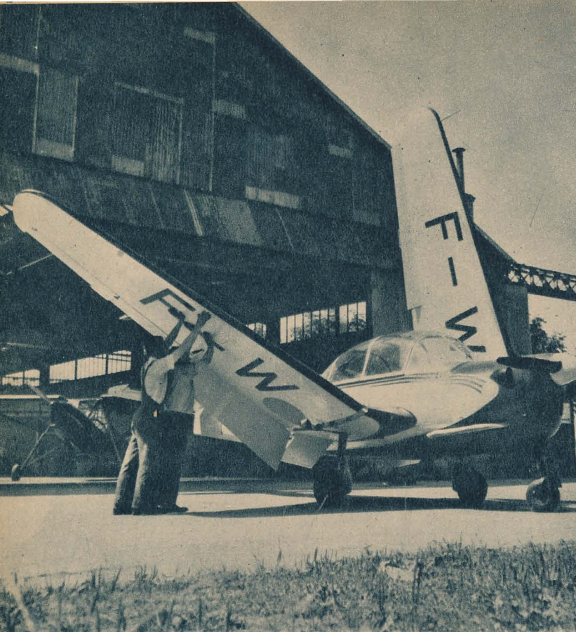
Två bilder av helmetallsportplanet Morane-Saulnier MS 571 som har fällbara vingar och en mycket elegant utformad bubbelliknande kabin.
