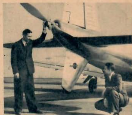
I föregående nummer av FLYG presenterades ett nytt lätt transportplan för fem personer — Douglas Cloudster. Här visas ännu en bild av planet med stjärtpropellerarrangemanget väl synligt. Propellerna som 6 är autonamtiskt omställbara och av Hamiltons Standard-typ drivs av två 200 hk motorer placerade i flygkroppens bakre del. Marschfarten anges till en 305 km/t.
