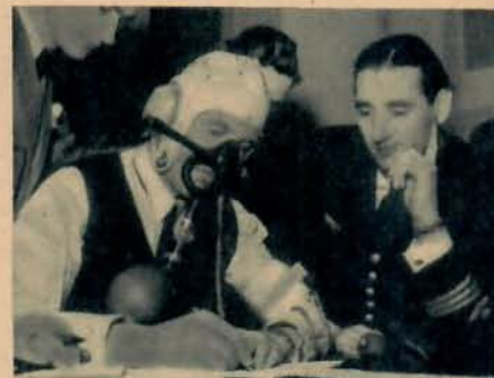
Kapten Bo Drangel genomgår ett prov med kväve- och syrgasblandningen där deltagarna »koloxidförgiftas» under det att de skall skriva siffrorna 1 000, 999, 998 osv. Det är alltid svårt att helt skydda sig mot koloxid från motorn och genom detta prov får man klart för sig hur hastigt reaktionsförmågan nedsätts vid sådan förgiftning. Då man efter ett par minuter skulle skriva sin namnteckning blev det i de flesta fall bara ett oölsligt klotter. Mannen till höger på bilden är chefen för kursen, kapten Kjell Rasmussen.
