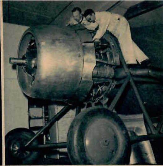
Denna unika »apparat» — som ABA torde vara ensam om i hela världen — används till att utbilda elever i varmkörning av en motor. För tillfället är det Bertil Lindström och Nils Stadius som lär sig anordningen.
