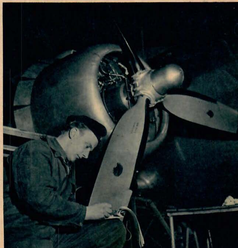
Förutom flygmekaniker behöver trafikflyget även annan specialutbildad teknisk personal. ABA har sålunda ordnat med utbildning av instrumentmekaniker och radiomontörer. På bilden t v kontrollerar Bertil Clementzler med stetoskop att det inte finns några vibrationer i kursgyron. — T h provlyssnar Karl-Gustav Bohlin en DC-3:as radio.
