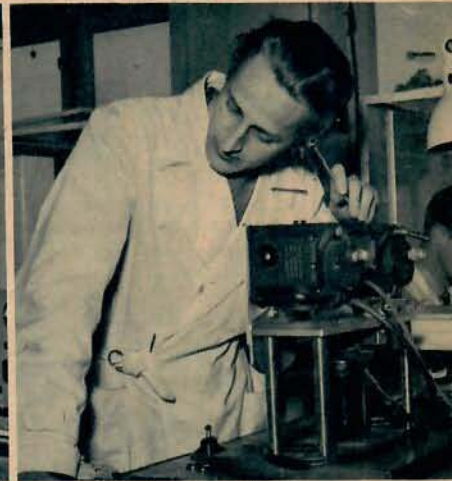
Förutom flygmekaniker behöver trafikflyget även annan specialutbildad teknisk personal. ABA har sålunda ordnat med utbildning av instrumentmekaniker och radiomontörer. På bilden t v kontrollerar Bertil Clementzler med stetoskop att det inte finns några vibrationer i kursgyron. — T h provlyssnar Karl-Gustav Bohlin en DC-3:as radio.
