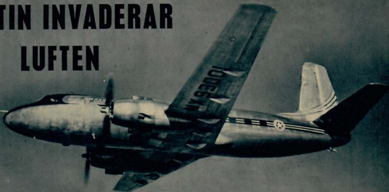
Martin 202 snett underifrån. Det långa »boksprö-tet» i nosen är ett extra pitotrör som användes vid provflygningarna. — På den infällda bilden ses en del av förarrummet med den välordnade instrumentpanelen.
