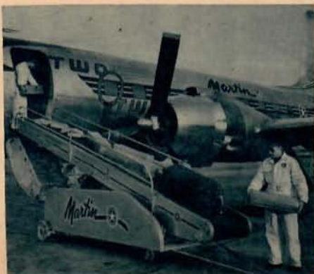
T v: Lossningen sker »på löpande band» med hjälp av den specialbyggda transportanordningen. Observera den »skilpta» spetsen på Hamilton-Standard-propellern. — T h: Den inbyggda trappan sitter i bakre delen av flygkroppen och manövreras av piloten.
