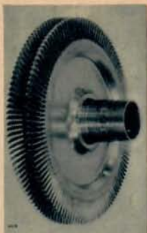
T h: Turbinhulet som driver kompressorn. — Nedan: Den sammanbyggda axial- och centrifugalkompressorn.
