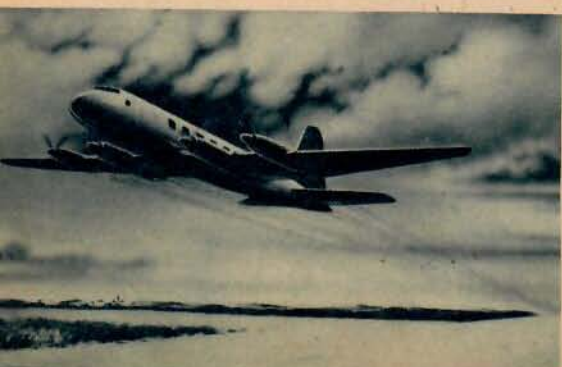
Handley Page Hermes V som skall utrustas med fyra Theseus propellerturbinaggregat.
