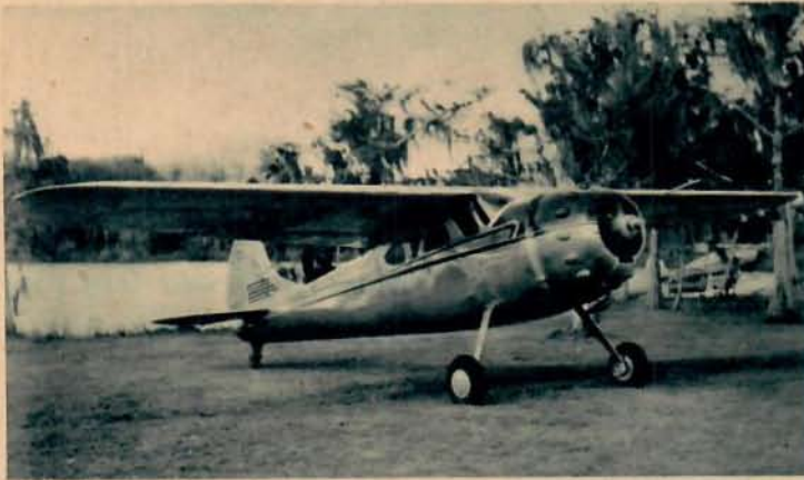
Cessna-fabrikerna har nyligen presenterat två nya 4-5-sitsiga rese- och firmaplan benämnda Cessna 190 och 195. Motorutrustningen på 190 är en 240 hk Continental-stjärnmotor medan 195 har en 300 hk Jakobs-d:o.
