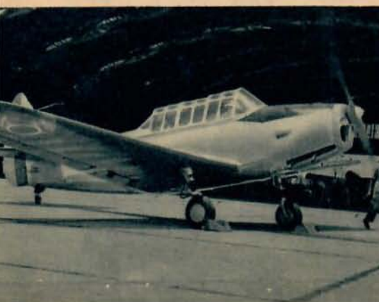
Ovan: HL-6 är ett brasilianskt övningsplan som i vissa vinklar påminner ganska mycket om Fairchild PT-19 »Cornell». Bilden visar HL-6A utrustad med 130 hk Franklin-motor. — Nedan: Fabrica do Galeao heter en fabrik i Rio de Janeiro som på uppdrag av det brasilianska flygvapnet tillverkar skolflygplan av typerna Fairchild PT-19 och PT-26 på amerikansk licens. Här nedan en PT-26 — eller Cornell som planet också kallas — i de brasilianska färgerna.
