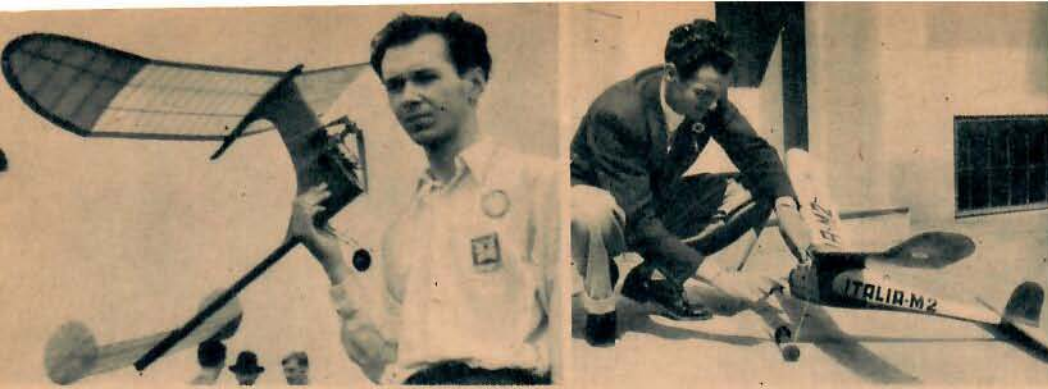
T. v.: Tjecken Igor Manka hade en dieselmodell med fällbar propeller och infällbart landställe vilket manövrerades med en speciell timer. — T. h.: Italienaren Volvino Pecorari placerade sig som tvåa i motorklassen och ses här pyssla om sin vackra dieselmodell. Motorn har en cylindervolym på 3 cm 3 och gör 7 150 v/min. Modellens spännvidd är 1 500 mm, sidoförhållandet 1:11 och vingprofilen NACA 6412.
