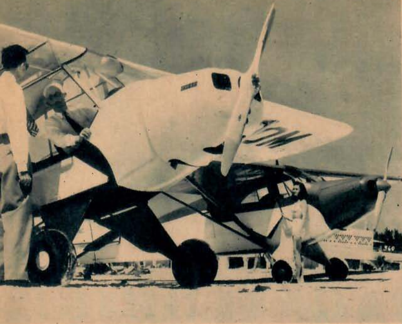
Den nya Cuben PA-11 ser rätt trevlig ut med sin helt inklädda motor å la Super Cruiser som förresten ses t. h. på bilden. Genom den nya motorinklädnaden har man lyckats höja den lilla Cubens fart med 25 procent.
