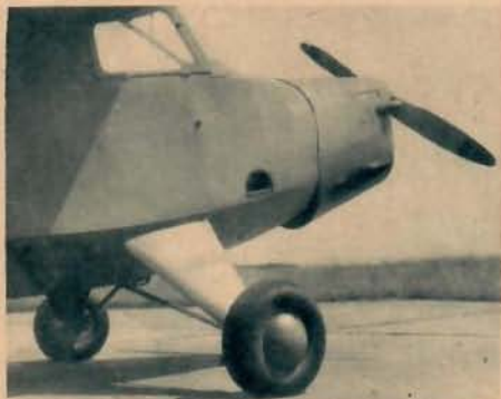
Praga E 114 Baby — beprövad tvåsitsare med originellt instigningsarrangemang — i versionen med 65 hk Walter Mikron III.
