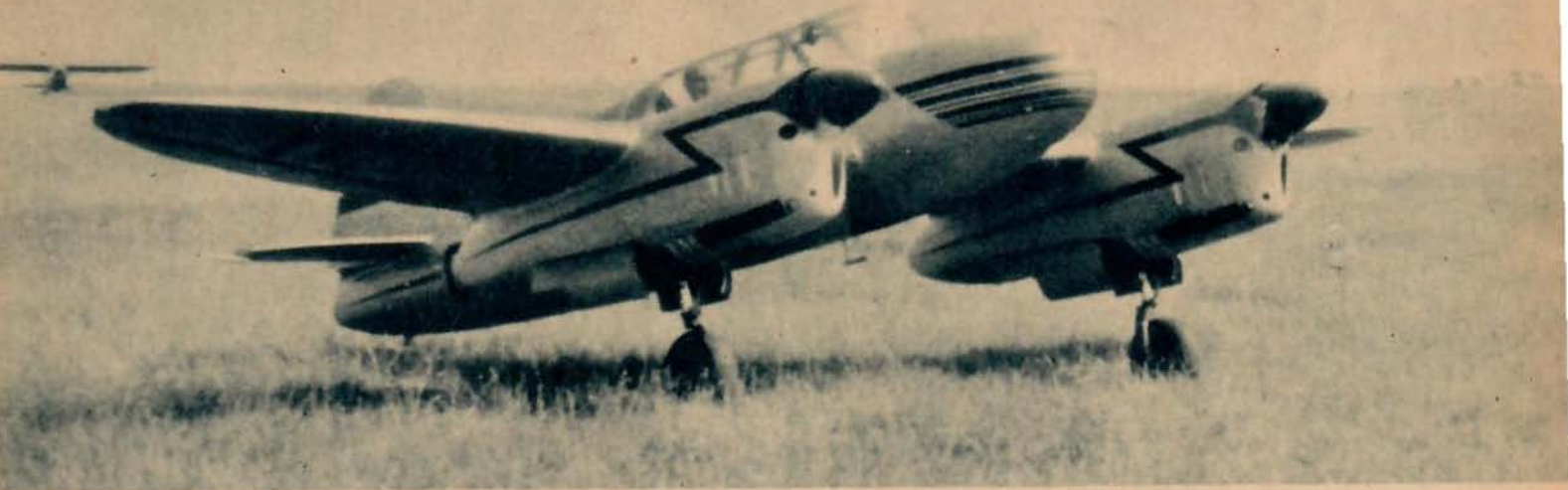
Ganska konventionell till utseendet, men i stället desto mer avancerad vad det konstruktiva beträffar är Hodek-fabrikens första flygplanskonstruktion — den tvåmotoriga och hypersnabba Hodek HK 101. Proven med prototypen pågår.
