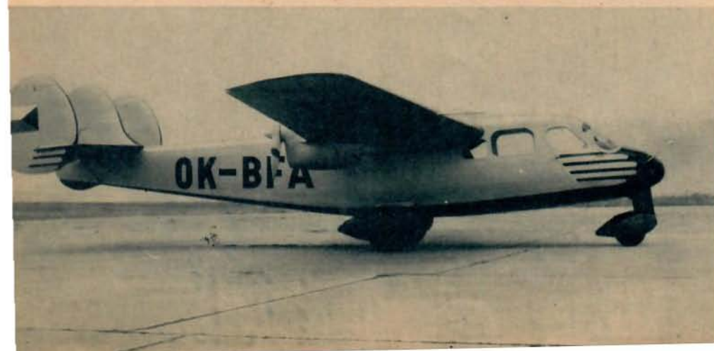
T. v.: Ganska ovanlig till sitt yttre är Praga-fabrikens 4-5-sitsiga taxiflygplan E 211. Två skjutande propellrar, vardera driven av en 165 hk Walter Minor 4-III-motor, är kraftkälla i denna underliga skapelse.
