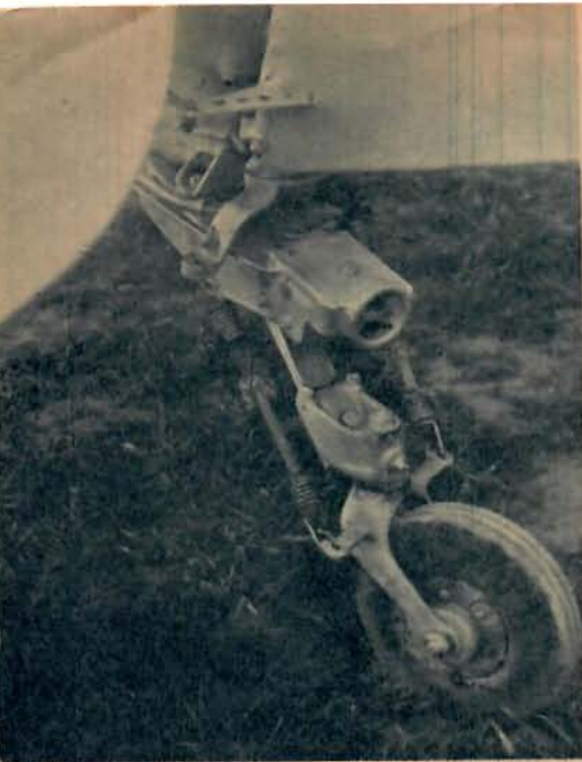
T. v.: Farner-Werke A. G:s kopplingsanordning på Piper Cub. Kopplingen är fästad på ett mellanstycke direkt på kroppen och här alltså inte förbindelse med sporrnen.
