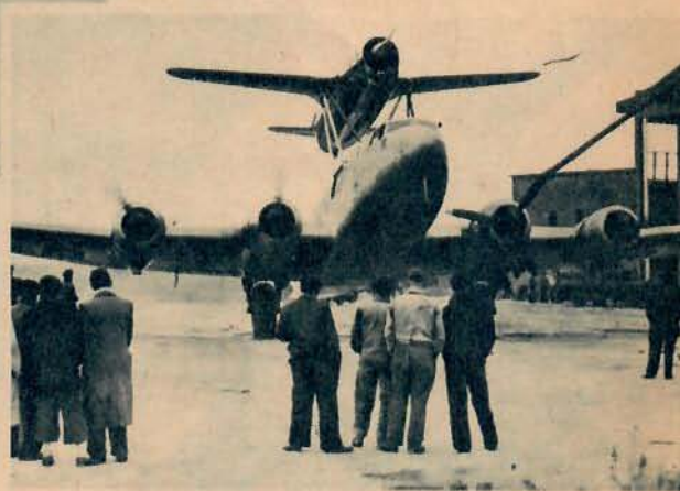
T. v.: Bristol Brigand, ett nytt tvåmotorigt attackflygplan för tre mans besättning. Planet skall efterträda Beauflighter som vann så stora lagrar under de nattliga flygstriderna över England. Beväpningen består av raketprojektiler under vingarna, fyra 20 mm:s automatkanoner på flygkroppens undersida och dessutom en rörlig kulspruta. Motorerna är Bristol Centaurus 57 med 18 cylindrar och en effekt på 2.500 hk. — Nedan: Första flygproven har gjorts med ett nytt franskt reaktionsflygplan — LEDUC 70 — som fick starta från ett transportplan.
