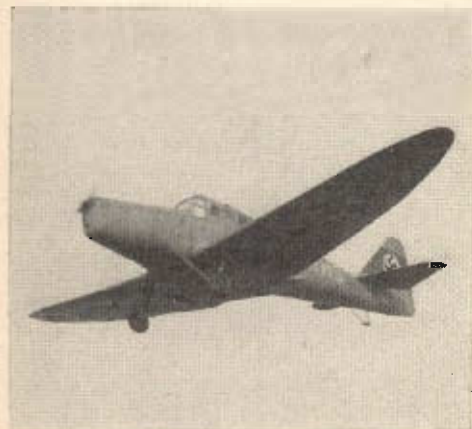
Klemm Kl 107. Motor Hirth HM 504 A 2 på 105 hk.
