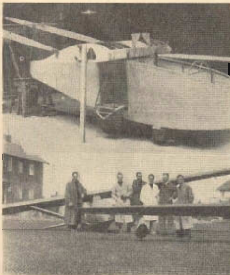
Bilden breddad rubriken visar sportamfibien med hjulen indragna och motorstativet utan motor. Härövan kroppen utan klädsel, hjulen utfällda. Nederst "kassgänget" framför segelplanet "Måsen" — t. h. ägaren Ing. Dahlén. Närmast synes amfibiens högervinge med stödfloötör.
