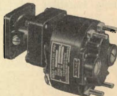
PESCO licenstillverkad hydraulisk pump typ S 214 H är en högtrycksoljepump för avloppstryck upp till 100 kg/cm 2 .
