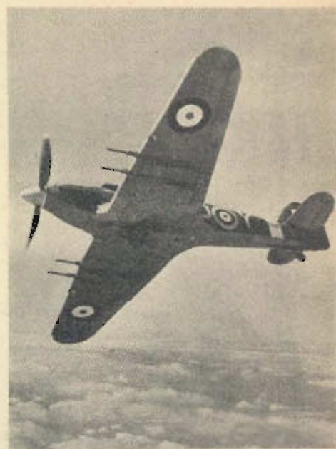
Hurricane Mark II-C, engelskt jaktplan med kanonbeväpning (fyra 20 mm automatkanoner i vingarna). Användes särskilt som låganfallsplan för bekämpning av stridsvagnar, bevakningsfartyg m. m.
