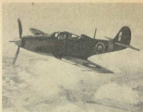
Bell Airacobra (P-39), det amerikanska jaktplanet i engelsk tjänst. Försett med en 20 mm automatkanon (i USA-flyget av 37 mm kaliber), skjutande genom propellern, samt 8 fasta ksp. Även levererad till Ryssland.
