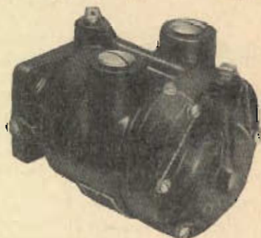
PESCO licenstillverkad vakuumpump typ S 207 C. Kapacitet 570 liter fri luft pr minut vid 3,500 varv/min.
