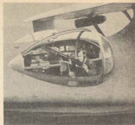
Consolidated Catalinas sidobeväpning, rörlig ksp i enkellavettage, placerat i blåslänkande utbuktning (midtskydd) i flygkroppens (båtkroppens) sida bakom vingstället.
