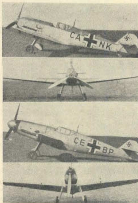
Här ovan några av de mest kända Me 109-typerna: Överst Me 109 E, därunder B, F samt D.
