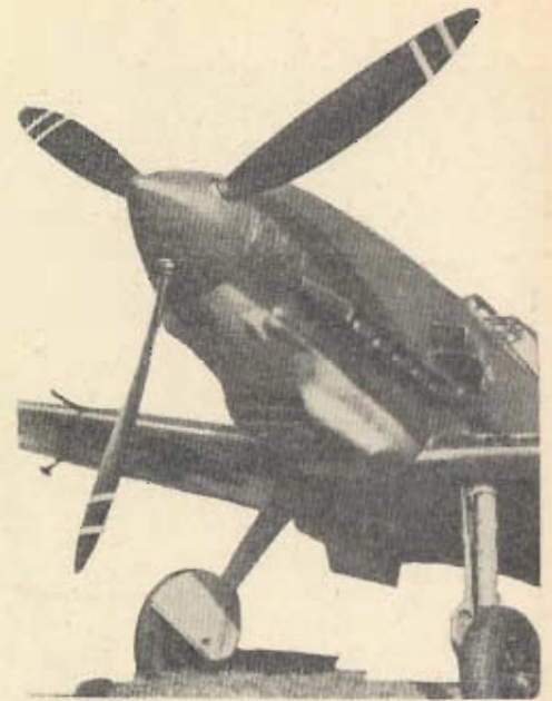
Ensidigt jaktplan med automatisk ställbar Escher Wyss-propeller.
