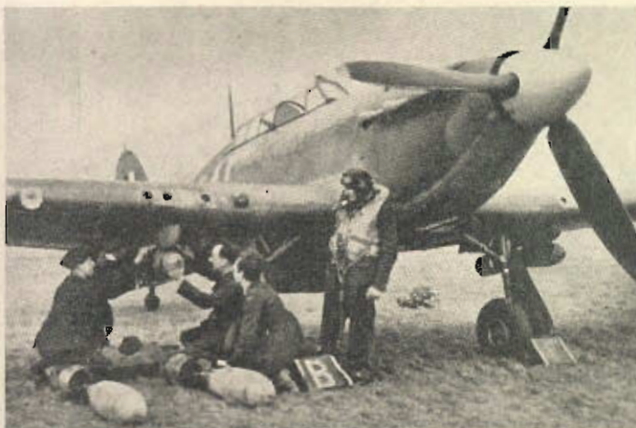
T. v. "laddning" av ett bombjaktplan typ Hurricane. Lägg märke till kameraöppningen (för "luftstridsfilmning") till höger om kulspjutorna.
