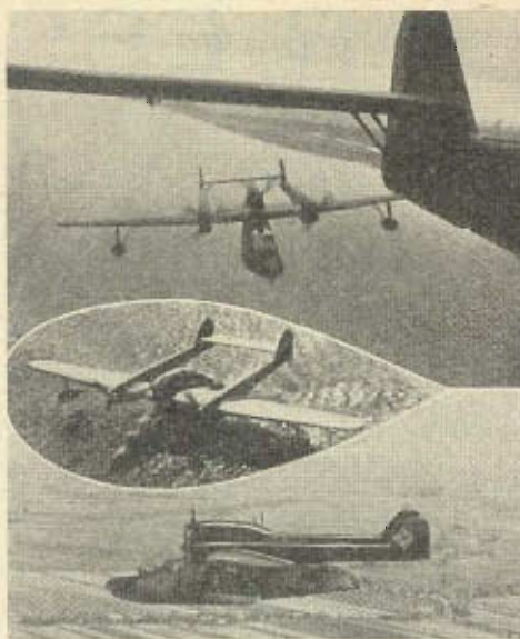
Den tyska flygbåten Blohm & Voss Bv 138 har tre motorer med den mellersta placerad ovanpå vingen. Sidomotorgondolerna ha förlängts bakåt och uppbära stjärtpartiet.
