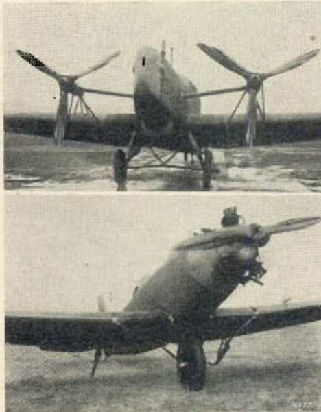
Två kuriösa flygplantyper som Junkers försöksavdelning haft att prova, överst en W 33 för propellerundersökningar; därunder ett försök med enhjuligt landningsställ och stödmedar på sportflygplanet Junkers Junior K 50.
